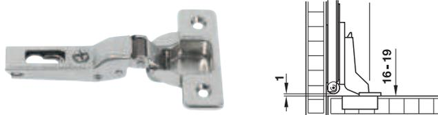
Esquema de taladros para la fijación de la cazoleta
