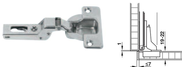
Esquema de taladros para la fijación de la cazoleta
