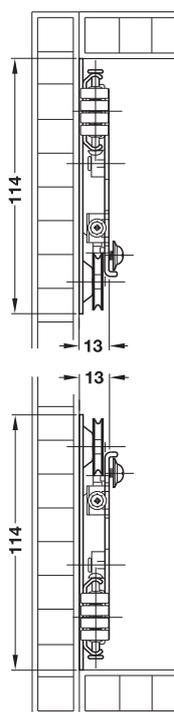
Montar las guías directamente en el tablero inferior o superior
